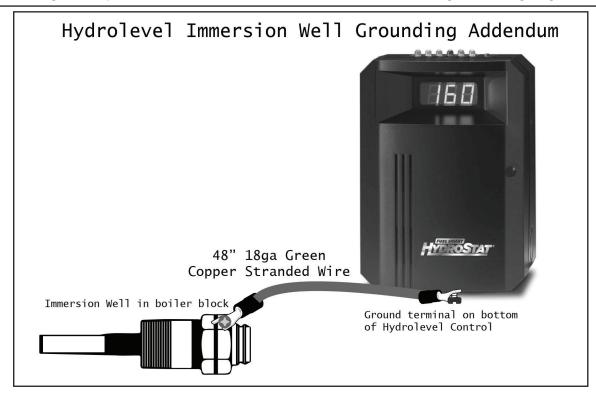
RIELLO, 7248/Hydrostat/Aquasmart, control wiring
